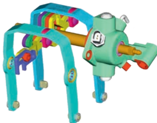
Innere Schaltung: Zusammen mit der Schaltgabel (blau) bildet der Schaltdom (grün) die innere Schaltung, das Übertragungselement vom Schalthebel zum Getriebe. Das perfekte Zusammenspiel aller Komponenten sorgt für eine leichtgängige Schaltung, deren Getriebe das Drehmoment optimal auf die Straße bringt.
