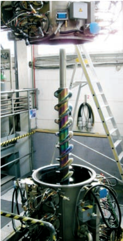
Die Anlagentechnologie ermöglicht die Beschichtung von Bauteilen mit Längen bis zu 4.500 Millimeter (links und oben) und großvolumigen Teilen mit Durchmessern bis 1.500 Millimeter und Höhen bis 1.800 Millimeter (Mitte und rechts).
