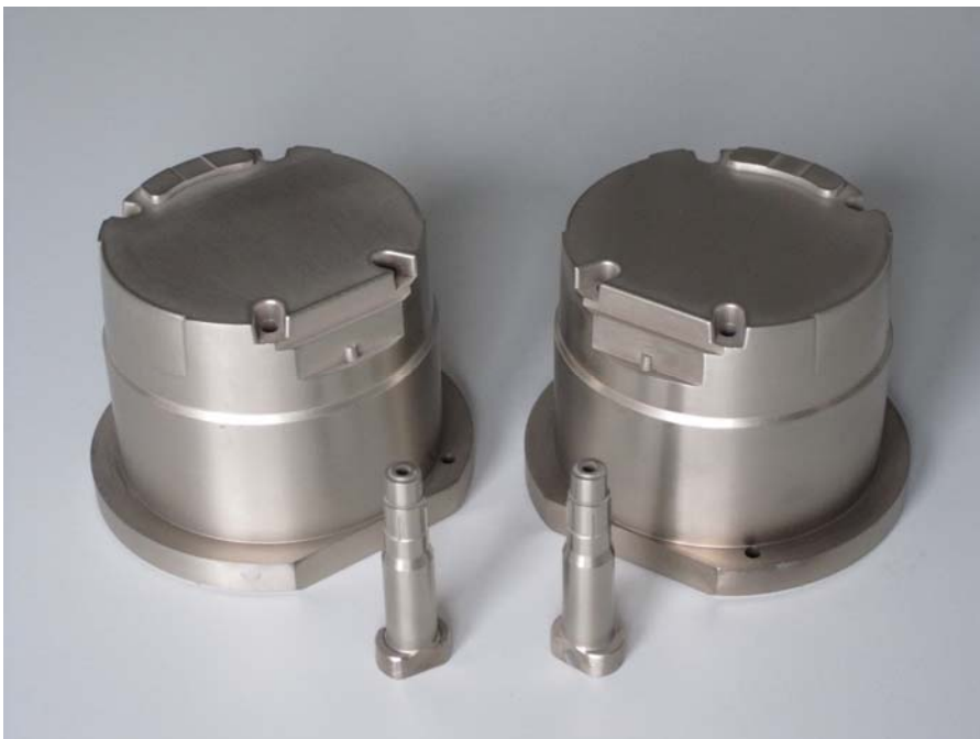
Bild: Kerne für den Aluminiumdruckguss
