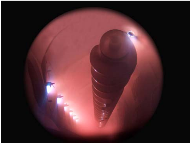
Bild 1: Extrusionsschnecke während der Beschichtung in der PVD-Anlage für Langteile
